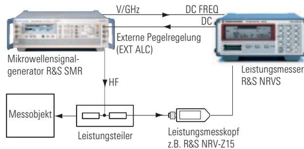
**Bild 7:** Externe Pegelregelung für die Mikrowellensignalgeneratoren R&S SMR50/60
