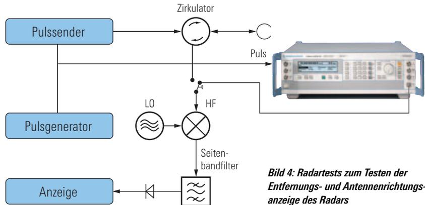
**Bild 4: Radartests zum Testen der Entfernung- und Antennenrichtungsanzeige des Radars**
