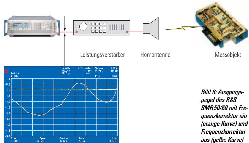
**Bild 6:** Ausgangspegel des R&S SMR50/60 mit Frequenzkorrektur ein (orange Kurve) und Frequenzkorrektur aus (gelbe Kurve)
