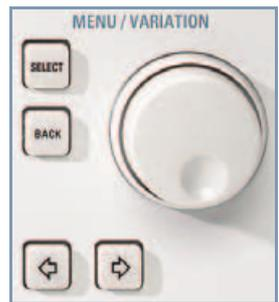
Bild 10: Generelle Einstellungen und Menüauswahl mit Drehknopf, Back, Select und Pfeiltasten
